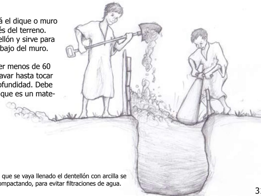
A medida que se vaya llenado el dentellón con arcilla se debe ir compactando, para evitar filtraciones de agua.
